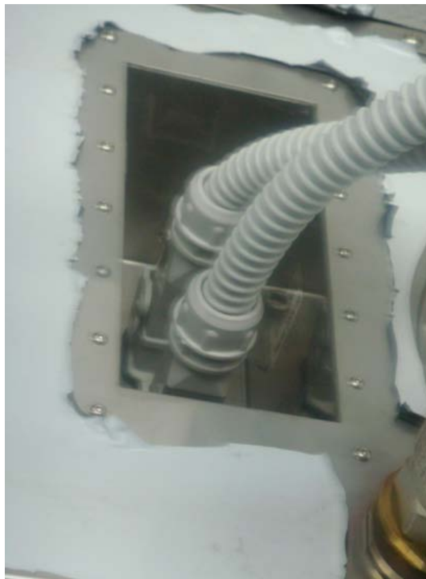
Foto collegamento cavi sul trasmettitore.
